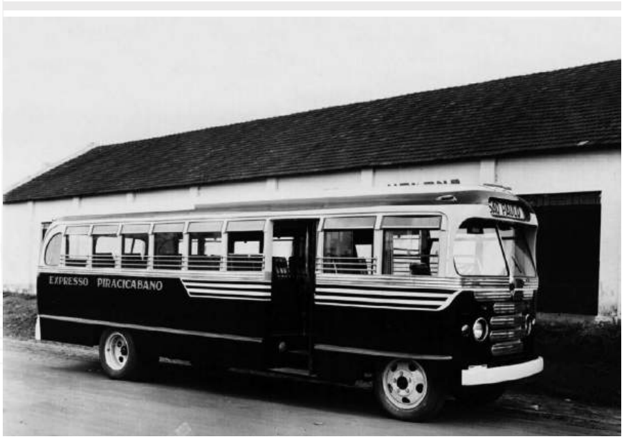
Foto 02 - Os primeiros ônibus fabricados aqui, no pós-guerra, ainda tinham uma configuração bem simples, porém, com os ideais do design marcante para a época e do layout interno que procurava oferecer melhores condições aos passageiros em suas viagens. Nesta foto, um modelo de carroçaria Caio sobre chassi Ford.
