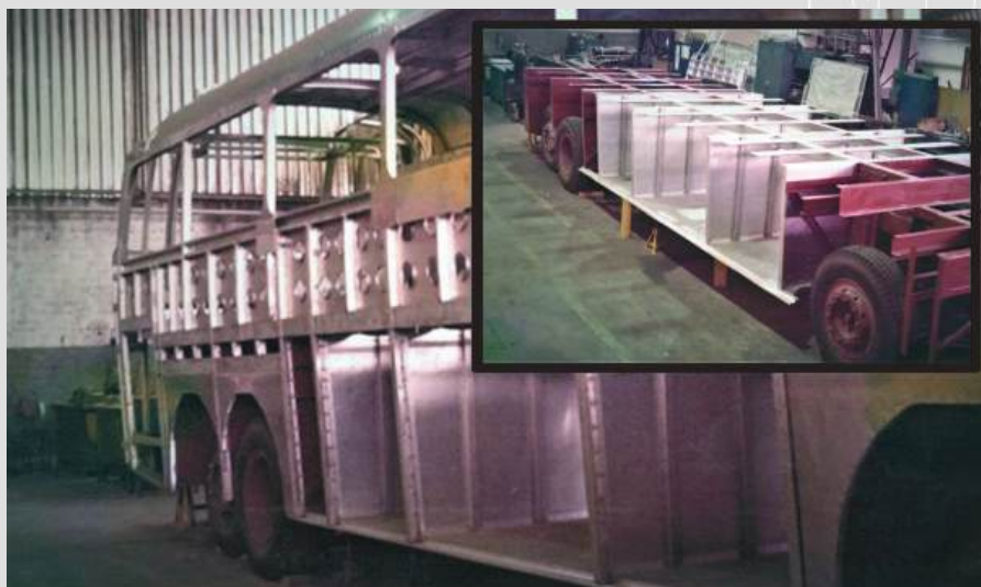
Fotos 11 e 12 - Na apresentação do primeiro ônibus modelo Tribus, Camilo Cola, então presidente da Viação Itapemirim, experimenta sua nova criação (foto acima). Abaixo, aspectos da construção do primeiro ônibus com três eixos para o serviço Executivo, uma inovação e tanto para a década de 1970.
