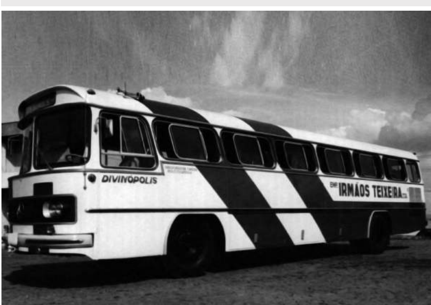
Foto 03 - Também, nos primeiros anos da década de 1970, a Mercedes-Benz lança o seu modelo integral O-355, muito requisitado pelos operadores brasileiros.
