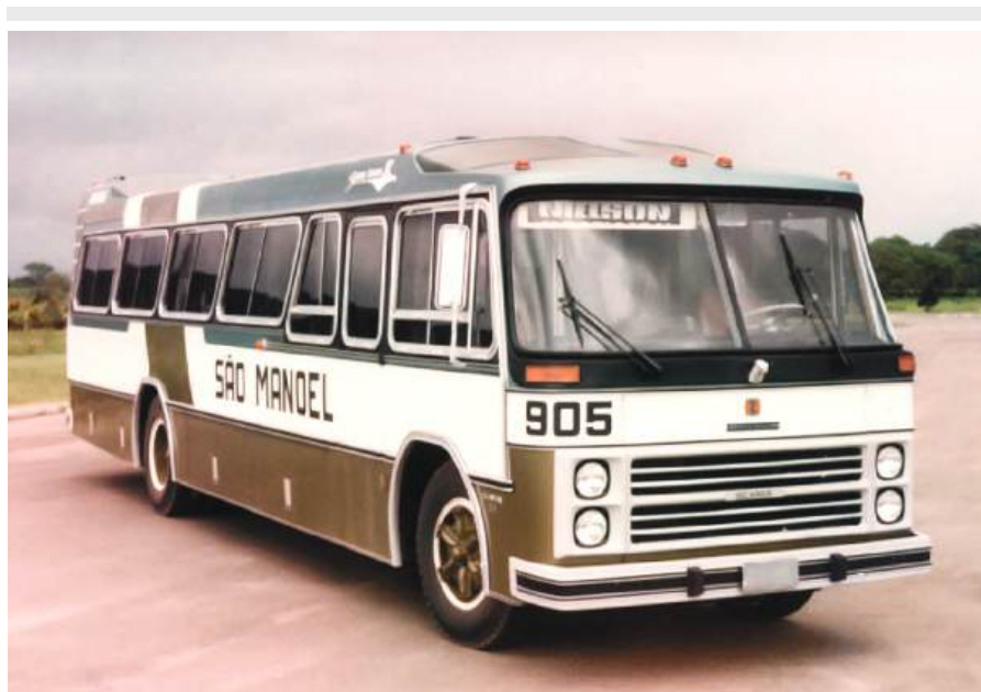
Foto 09 - Um possante modelo com chassi Scania B 110 e carroçaria Diplomata durante a segunda metade da década de 1970.
