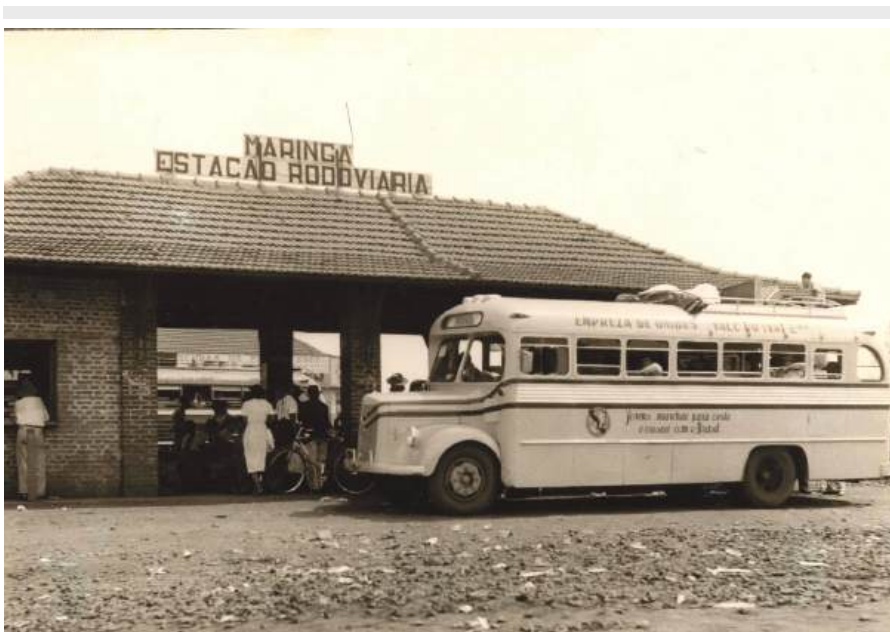
Foto 02 - Um caminhão L-312 Mercedes-Benz servindo de base para um ônibus do transporte rodoviário no norte paranaense.
