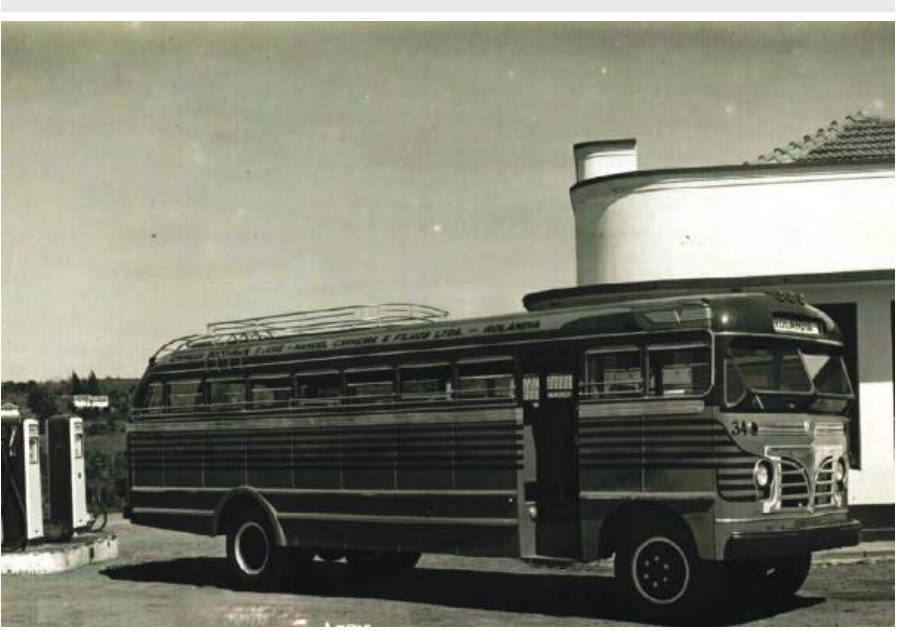
Foto 02 - Modelo de carroçaria Caio para o transporte rodoviário, com um visual típico para a época. Detalhe o para-brisa inusitado.
