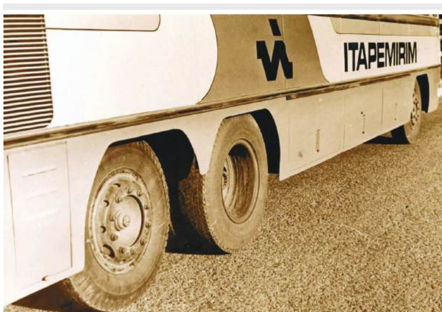
Foto 01 - O pioneirismo do ônibus com três eixos se deu pelo projeto de transformar um modelo monobloco O-326 da Mercedes-Benz.
