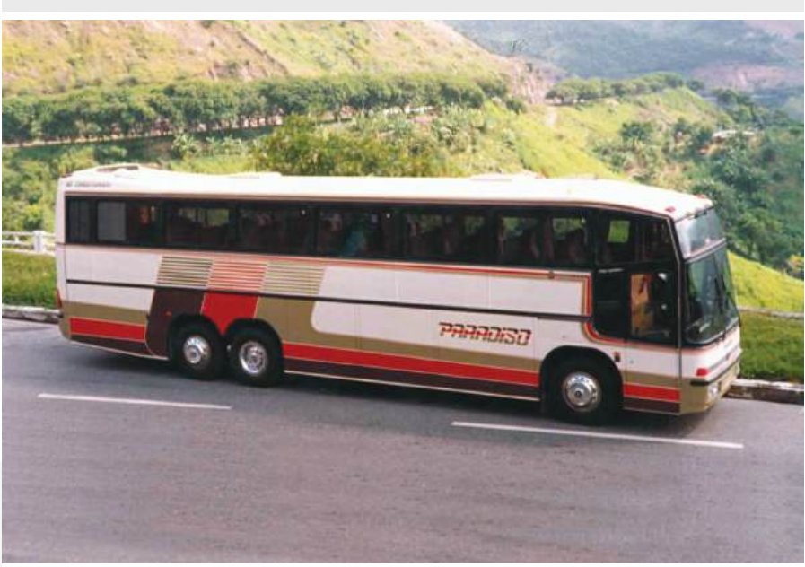
Foto 04 - É nesta década que o terceiro eixo virou um elemento constante nos modelos maiores de ônibus rodoviários, como este Paradiso Geração IV.
