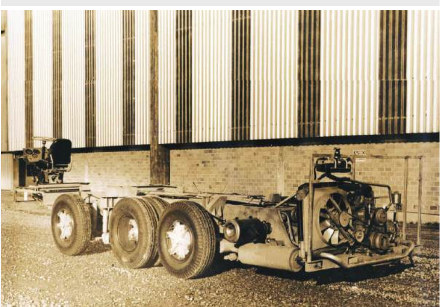
Foto 09 - Chassi Scania com o terceiro eixo, um dos primeiros da categoria no Brasil.
