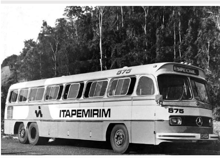
Foto 02 - A engenharia caseira da Viação Itapemirim desenvolveu os primeiros protótipos do ônibus 6x2.
