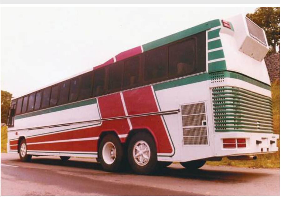
Foto 07 - A gaúcha Marcopolo usou de sua experiência na produção de ônibus rodoviário para criar um modelo com terceiro eixo na base do chassi Scania.
