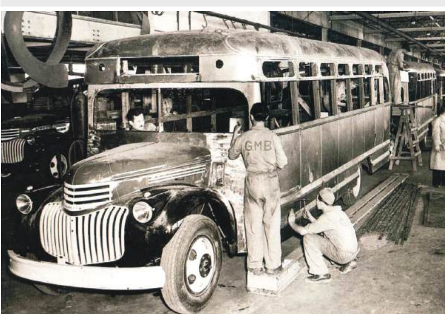
Foto 01 - Linha de montagem de ônibus da marca General Motors do Brasil, com modelos que eram utilizados tanto no mercado urbano, como no segmento rodoviário.
