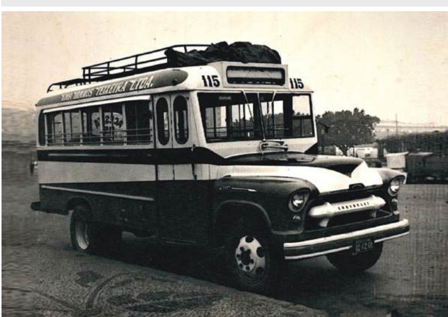
Foto 03 - Modelo de ônibus muito comum na década de 1950 para o transporte intermunicipal. Na foto, um caminhão Chevrolet, ano 1957, transformado em ônibus.
