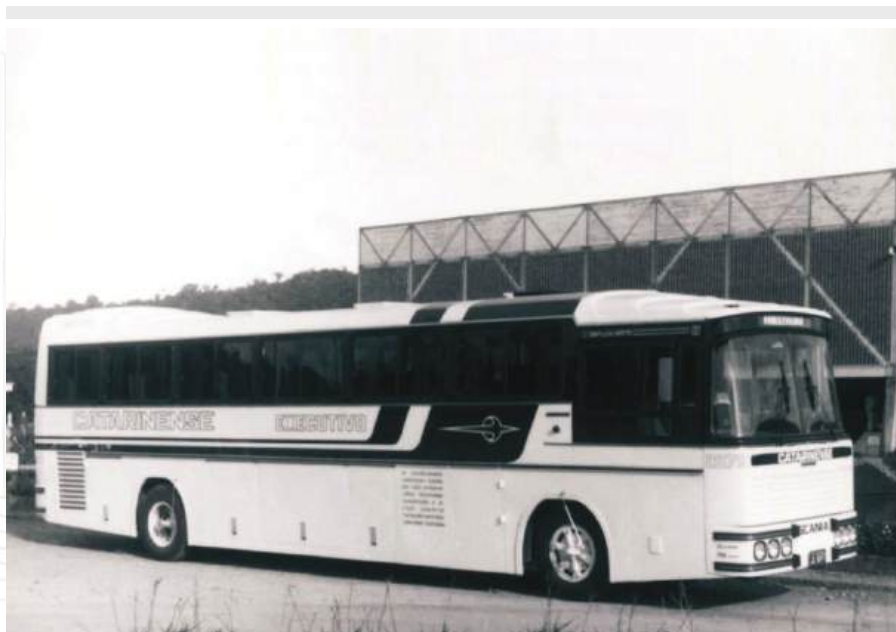
Foto 07 - Uma das primeiras carroçarias com o novo comprimento determinado pelo Decreto Federal de nº 82.925. Nesta imagem podemos ver o modelo Diplomata, da extinta marca Nielson, com uma configuração diferente para a época, com porta no entre-eixos, WC junto a ela e piso do salão mais alto. A iniciativa desse projeto veio de Heinz Kumm, então proprietário da Auto Viação Catarinense .
